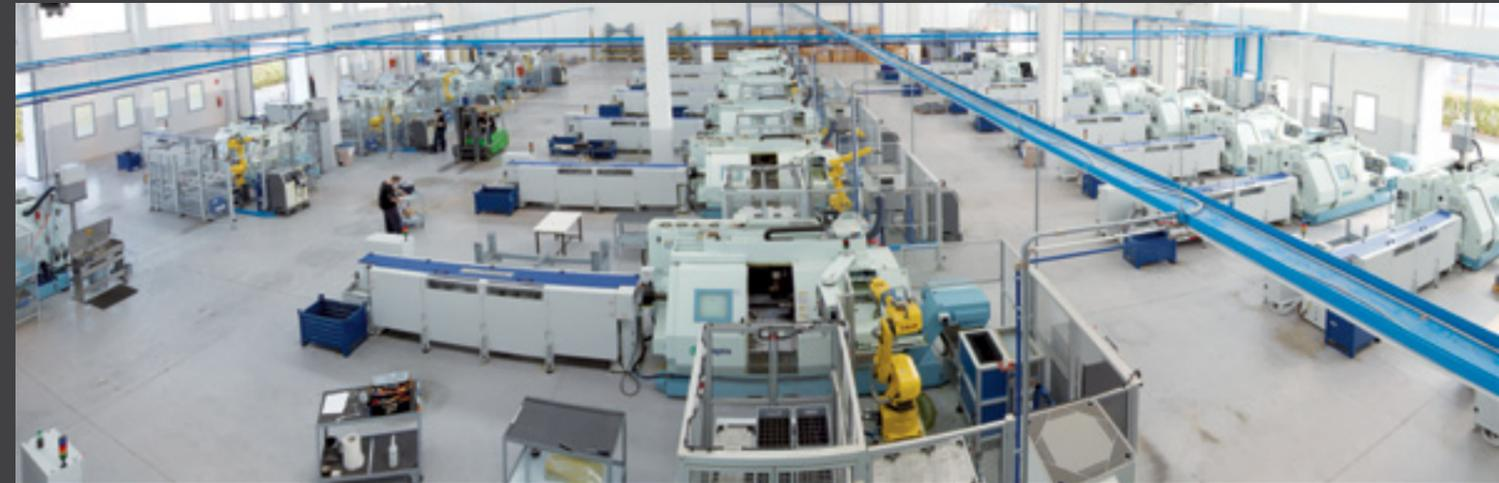
TORNI CNC CON ISOLE ROBOTIZZATE
